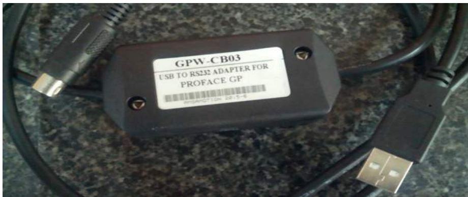
Hình 2.3. HMI kết nối với PC Thông qua cáp nạc GPW – CB03.
