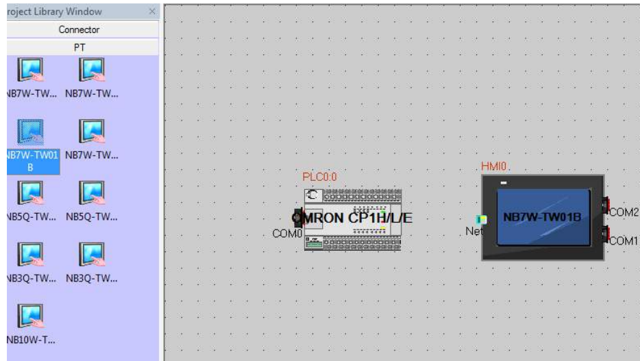
Hình 2.5. PLC kết nối với HMI.
