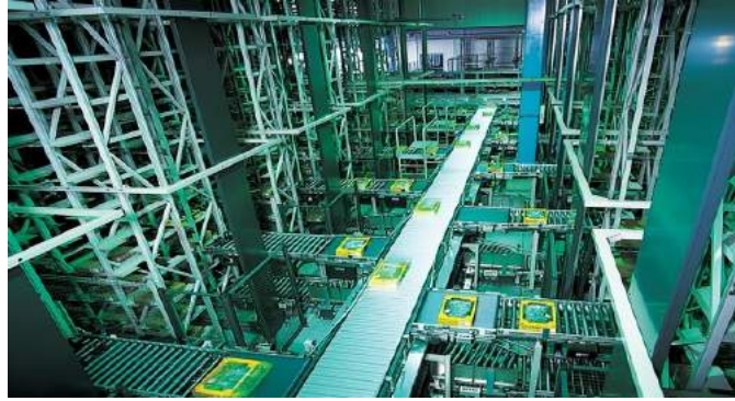
Hình 1.4. Hệ thống kho hàng tự động.
