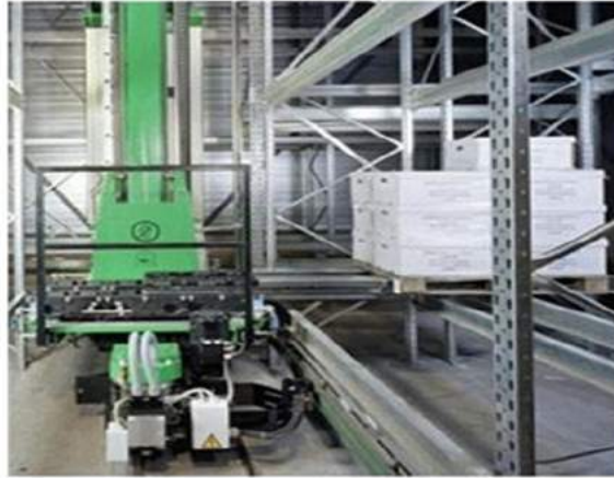
Hình 1.5. Cơ cấu robot vận chuyển sản phẩm vào kho.
