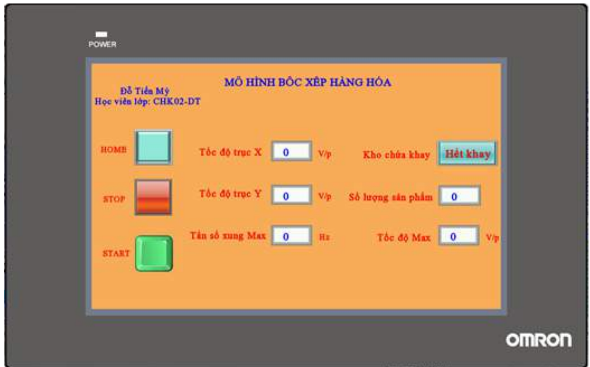
Hình 3.3. Giao diện điều khiển dây chuyền bốc xếp hàng hóa tự động.
