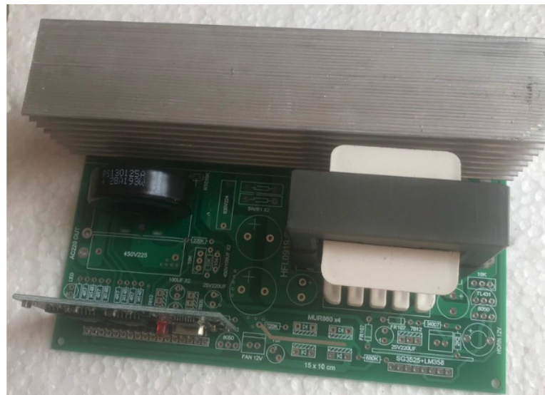
Hình 3.10. Lắp linh kiện lên mạch in
