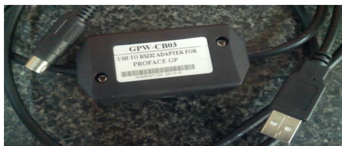
Hình 3. 16. HMI kết nối với PC Thông qua cáp nạp GPW – CB03
