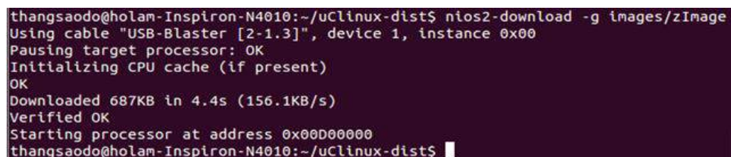
Hình 3.43: Nạp thành công uClinux lên bảng Altera DE2 với nios2
