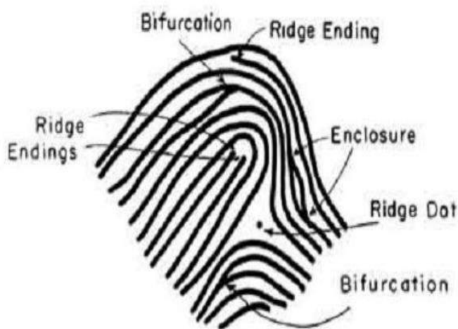
Hình 2. 4 Các điểm Minutiae Ridge Ending (điểm kết thúc) và Bifurcation (điểm rẽ nhánh) [7]
