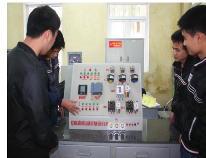
Sinh viên khoa Điện vận hành thử nghiệm hệ thống điều khiển, giám sát trạm biến áp Đê tài đạt giải tại Hội thi Sáng tạo kỹ thuật tỉnh Hải Dương lần thứ IX - năm 2015
