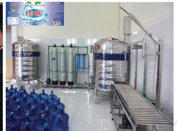
Dây chuyền sản xuất nước tinh khiết đóng bình khoa Thực phẩm và Hóa học Bottled fresh water manufacturing line Faculty of Chemistry and Food
